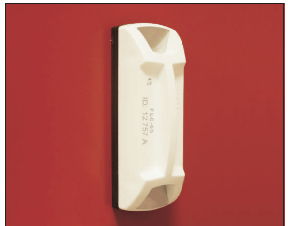
obr. 22 - tag FLC-05 na stavebním stroji
